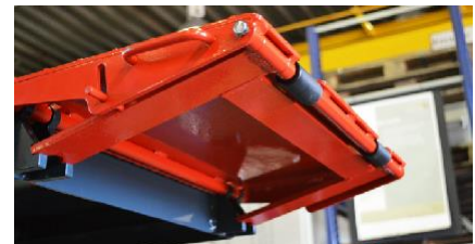
Vakaat nousurampit, kynnepeltiä, helpottaa nostimelle ajoa
