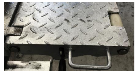
Vakaat, galvanoidit rampit tehty kynnepelistä
