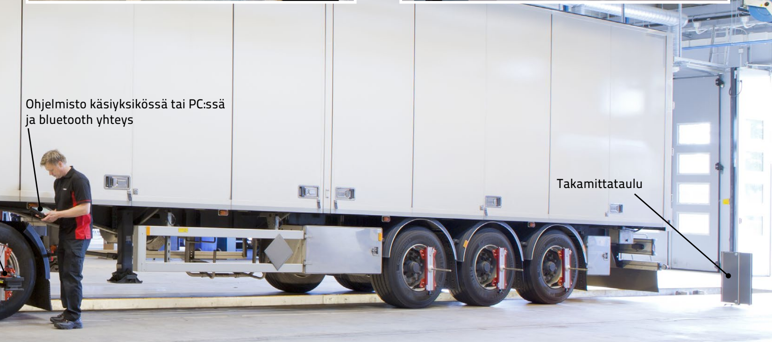
Perävaunutankoa käytetään puoli- ja täysperävaunujen mittauksissa
