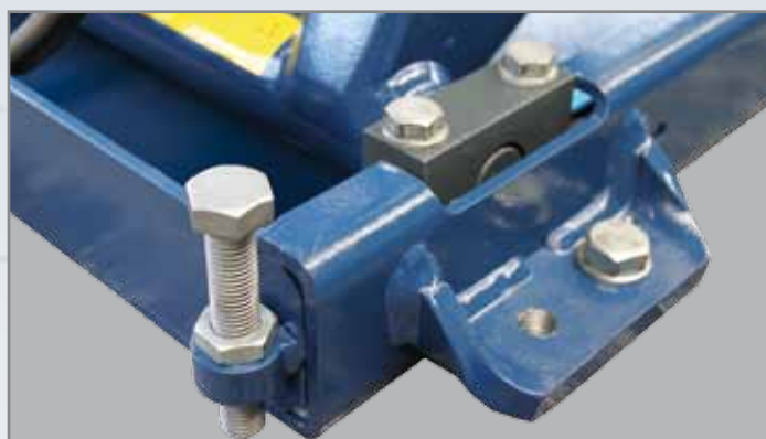
Kuumagalvanoidut mutteri ja ruuvit tai sinkki pinnoitetut osia käytetään korroosiolle herkissä paikoissa. Hydraulijärjestelmän liittimet ovat sinkki-nikkeli pinnoitetut
