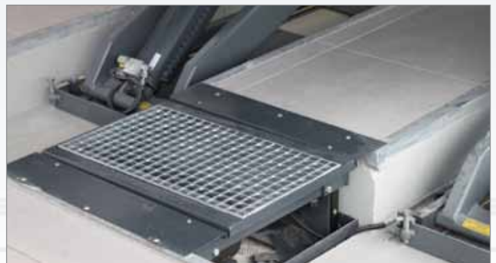
Akselikeventimen alla on nouseva lattian tasausritilä.
