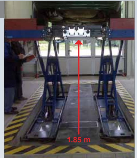
Keskiosan kohdalla on vielä vapaata korkeutta 1850 mm keventimen alla.
