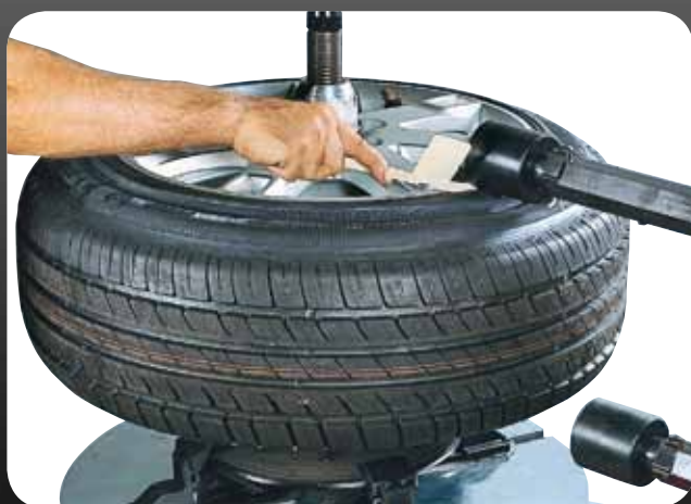
● INSERIMENTO DELLA REGLETTE ● FITTING THE "RÉGLETTE"
